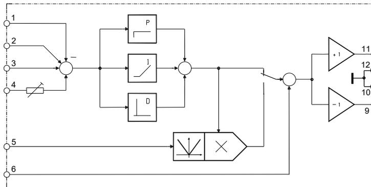
Zur Bildung der Soll-/Istwert Differenz hat das Gerät drei gleichbewertete Eingänge [1, 2, 3] von denen einer invertierend [1] arbeitet. Die Anschlüsse lassen sich durch Schließen der zugehörigen Schalter auch als Stromeingänge (0/4...20 mA) betreiben. Für einen Istwertabgleich ist ein weiterer Eingang [4] mit Vorwiderstand "R8" und Abgleichtrimmer "R5" vorhanden. "R8" kann, für die Normierung des Istwertes, nach folgender Formel berechnet werden (gilt für Mittelstellung von "R5"):
