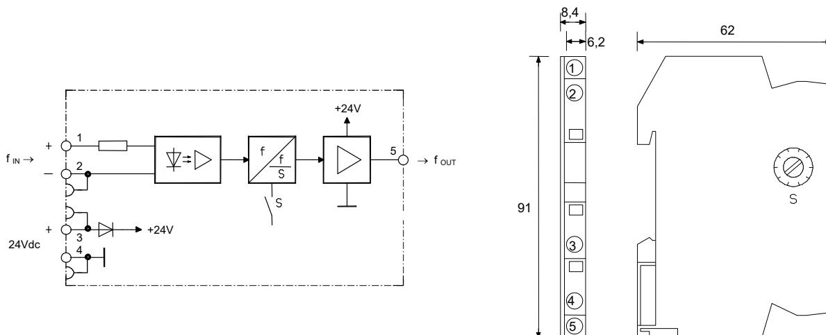
**Hinweise:** Die Geräte werden im geschlossenen Gehäuse (montierte Abschlussplatte) geliefert. Durch entfernen der Abschlussplatte ist der Drehschalter "S" zugänglich und man erreicht die schmalste Bauform von 6,2mm.
