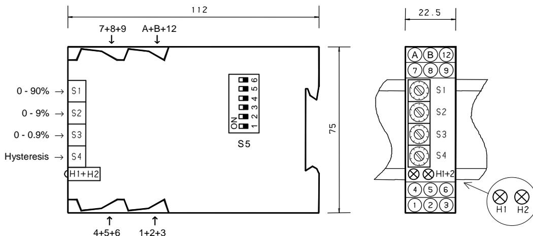
L'apparecchio si monta su guide DIN TS35 e viene alimentato con 24Vdc. La tensione di alimentazione è isolata galvanicamente dai segnali. In questo modo esiste una vera separazione a tre vie tra alimentazione, ingressi analogici e valori di uscita.
