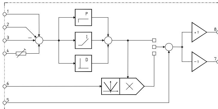
Zur Bildung der Soll-/Istwert Differenz hat das Gerät drei gleichbewertete Eingänge [1, 2, 3] von denen einer invertierend [3] arbeitet. Die Anschlüsse lassen sich durch Umstecken der zugehörigen Jumper auch als Stromeingänge (0/4...20 mA) betreiben. Für einen Istwertabgleich ist ein weiterer Eingang [4] mit Vorwiderstand "R8" und Abgleichtrimmer "R5" vorhanden. "R8" kann, für die Normierung des Istwertes, nach folgender Formel berechnet werden (gilt für Mittelstellung von "R5"):
