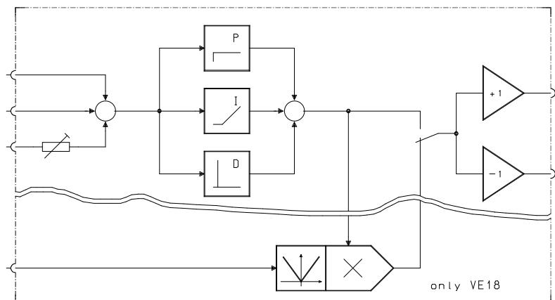
Für die Bildung der Soll-/Istwert-Differenz befinden sich zwei gleich bewertete Eingänge auf der Karte. Sollte ein Istwertabgleich erforderlich sein, steht ein zusätzlicher Eingang mit Spannungsteiler, bestehend aus „R21“ (frei beschaltbar) und „R5“ (Poti) zur Verfügung.
