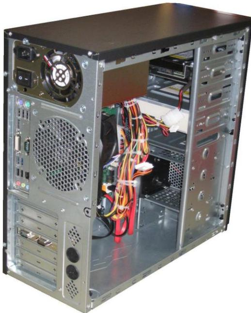
Alle Komponenten sind für den 24/7 Dauerbetrieb ausgelegt. Das Mainboard im µATX-Format verfügt über einen zusätzlichen USB-Anschluss im Gehäuse für den zugriffssicheren Anschluss z.B. eines Dongles. Als Spannungsversorgung dient ein 300-Watt Industrie-ATX-Netzteil.
