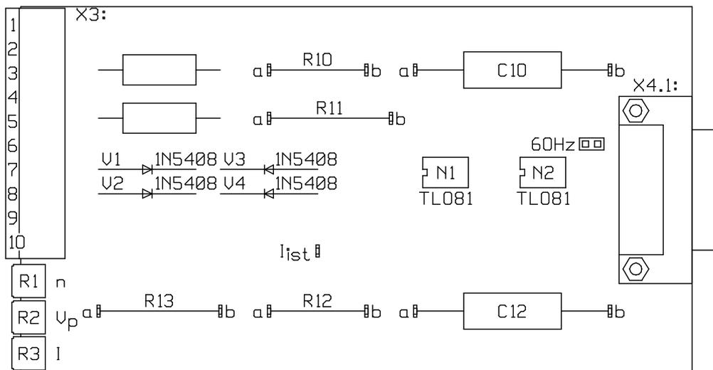
Der Hauptsollwert an Klemme X3:1 ist mit 0 bis +10V normiert. Bei jedem anderen Sollwert wird der Eingang X3:2 benutzt und R11 nach Bedarf bestückt. Dieser Eingang kann auch für ein Normsignal 0 bis 20mA benutzt werden, wenn der Platz R13 mit einem 100 Ohm-Widerstand bestückt und der Platz R11 eine Brücke eingelötet wird. Der Drehzahlwertabgleich erfolgt mit dem Poti „n“ in einem Einstellbereich von 1:4. Rechtsdrehung bedeutet höhere Drehzahl.
