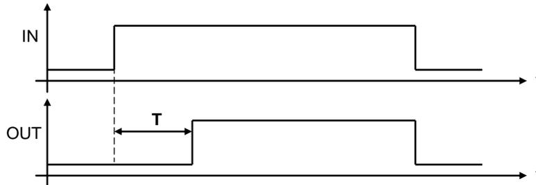
Die Einstellung der Verzögerung erfolgt mit den Dip-Schaltern "S1", "S2" und dem Spindeltrimmer "R". Mit dem Dip-Schalter "S3" lässt sich bei Bedarf der Ausgang invertieren.
