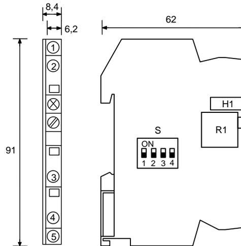
**Hinweise:** Die Geräte werden mit geschlossenem Gehäuse (montierte Abschlussplatte) geliefert. Durch entfernen der Abschlussplatte erreicht man die schmalste Bauform von 6,2mm.
