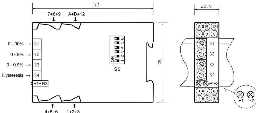
Das Gerät ist aufrastbar auf Hutschiene TS35 und wird mit 24Vdc versorgt. Die Versorgung ist von den Signalen galvanisch getrennt. So existiert eine echte 3-Wege-Trennung zwischen Versorgung, Analogeingängen und Schaltausgängen.
