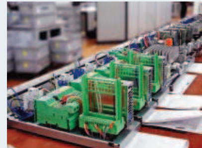
Wandlungsfähig: Steckverteiler mit Bus-Fähigkeit sorgen dafür, dass die Daten von analogen Bauteilen direkt vor Ort erfasst und in digitale Signale umgewandelt werden
