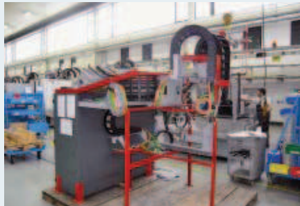
Komplett: Eine hybride Baugruppe (im Bild Energiebaushuttle mit Steuerung und Fluidkomponenten) erleichtert dem Kunden den Einbau erheblich Bild: Schweiger
